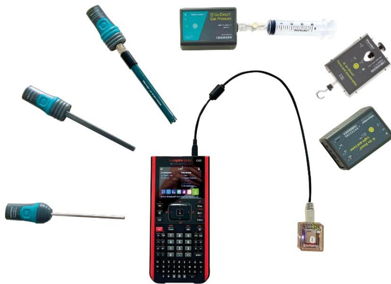
Figuur 2: mogelijke sensoren die gekoppeld kunnen worden via de TI-bluetooth adapter met de TI-Nspire of de TI-84 plus Python edition.
