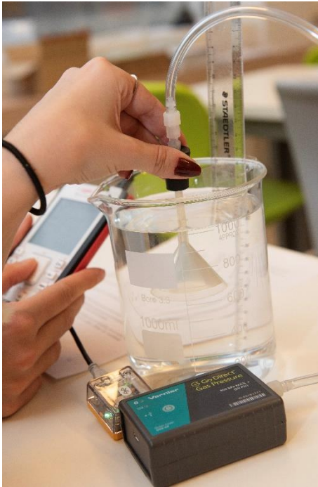
Figuur 15: proefopstelling bij meting hydrostatische druk
