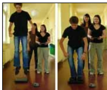
Sprung auf der Kraftplatte mit Voyage™ 200, CBL 2™ und Beschleunigungssensor
