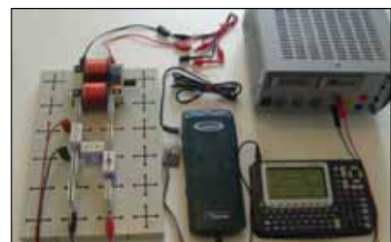
Versuch II mit Voyage™ 200 und LabPro®: Ein- und Ausschaltvorgang
