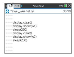
Eine andere Verzögerung der sleep()-Anweisung ist u.U. sinnvoll. Versuchen Sie jetzt, das Programm auszuführen und schütteln Sie das micro:bit. Auf dem micro:bit sollten zwei Zahlen angezeigt werden.
