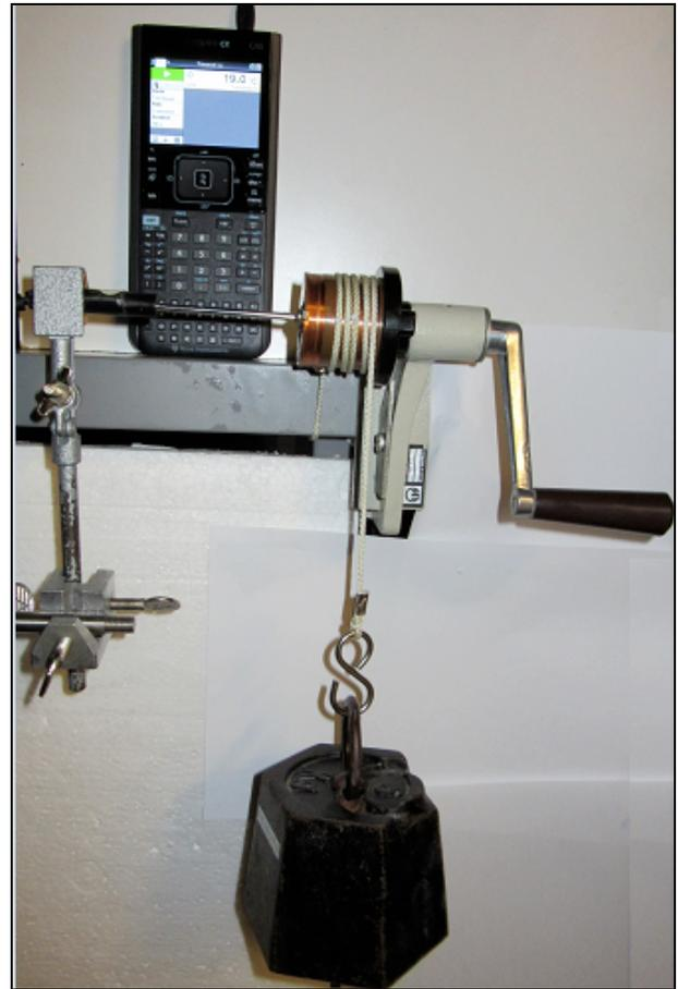
Abb.3: Apparatur zum Wärmeäquivalent mit Temperatursonde (Vernier)
